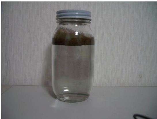
「TACO-Q」水面の浮上試験
